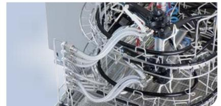
Die Adapter am Basismodul festschrauben, wie im Bild gezeigt. Dabei immer das obere Endoskop an die oberen Schläuche und das untere Endoskop an die unteren Schläuche anschließen.
