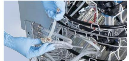
Den Zustand der Adapterdichtungen überprüfen. Alle Klemmen und Dichtungen müssen in einwandfreiem Zustand sein.
