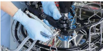
Beide Anschlüsse des Hauptadapters sicher am Endoskop anschließen. Die Verbindung muss fest und stabil sein.
