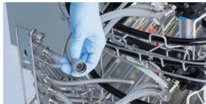
Überprüfen, ob in jedem Adapter eine schwarze Dichtung sitzt. Überprüfen, ob an jede Auslassöffnung entweder ein Schlauch oder ein Blindstopfen angeschlossen ist.
