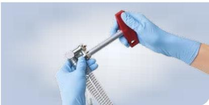
Schadhafte oder verschlissene Dichtungen austauschen! Immer nur den kompletten Dichtungssatz austauschen.
