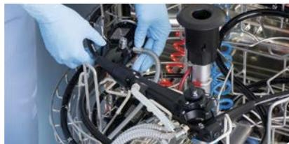
Den weißen Schlauch an den Hilfsspülkanal im Lichtleiterbereich des Endoskops anschließen.
