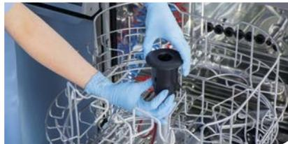
Wenn es eine Lücke gibt zwischen dem schwarzen Stutzen am Korb und dem Stutzen oben, dann den Stutzen am Korb in der Höhe verstellen, bis er dicht sitzt.
